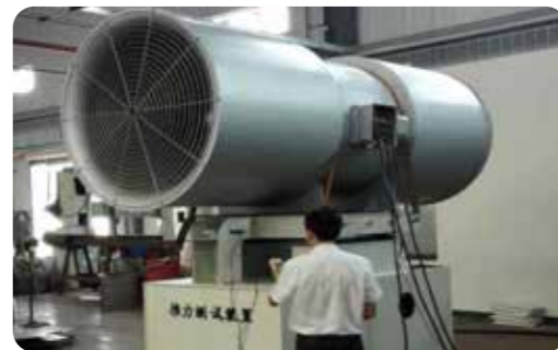
Jet Fan Thrust Test
